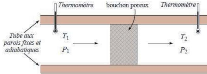
FIG. 5.3 – Dispositif pour mettre en évidence la détente de Joule-Thomson.
